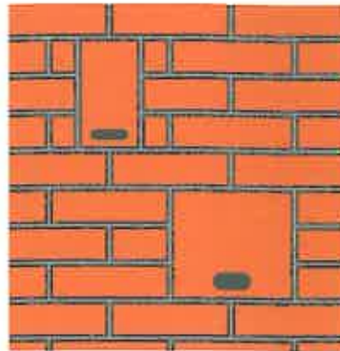
Sondermiststein aus Ton: für Mauersegler und Fledermäuse, zum Einbau in Ziegelmauerwerk, auch für historische Gebäude geeignet. Rechts: im Mauerwerk
